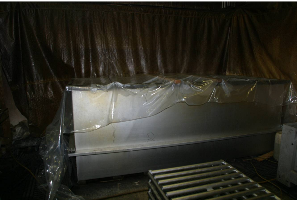
Kuva 2. Peittäusallas peitettynä muovilla
