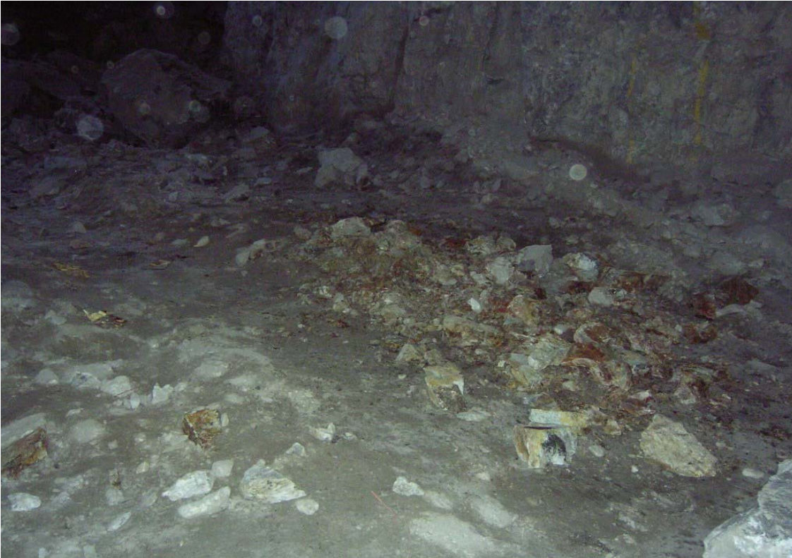
Kuva 5. Tapaturman aiheuttanut kivi hajonneena kaivostunnelin lattialla
