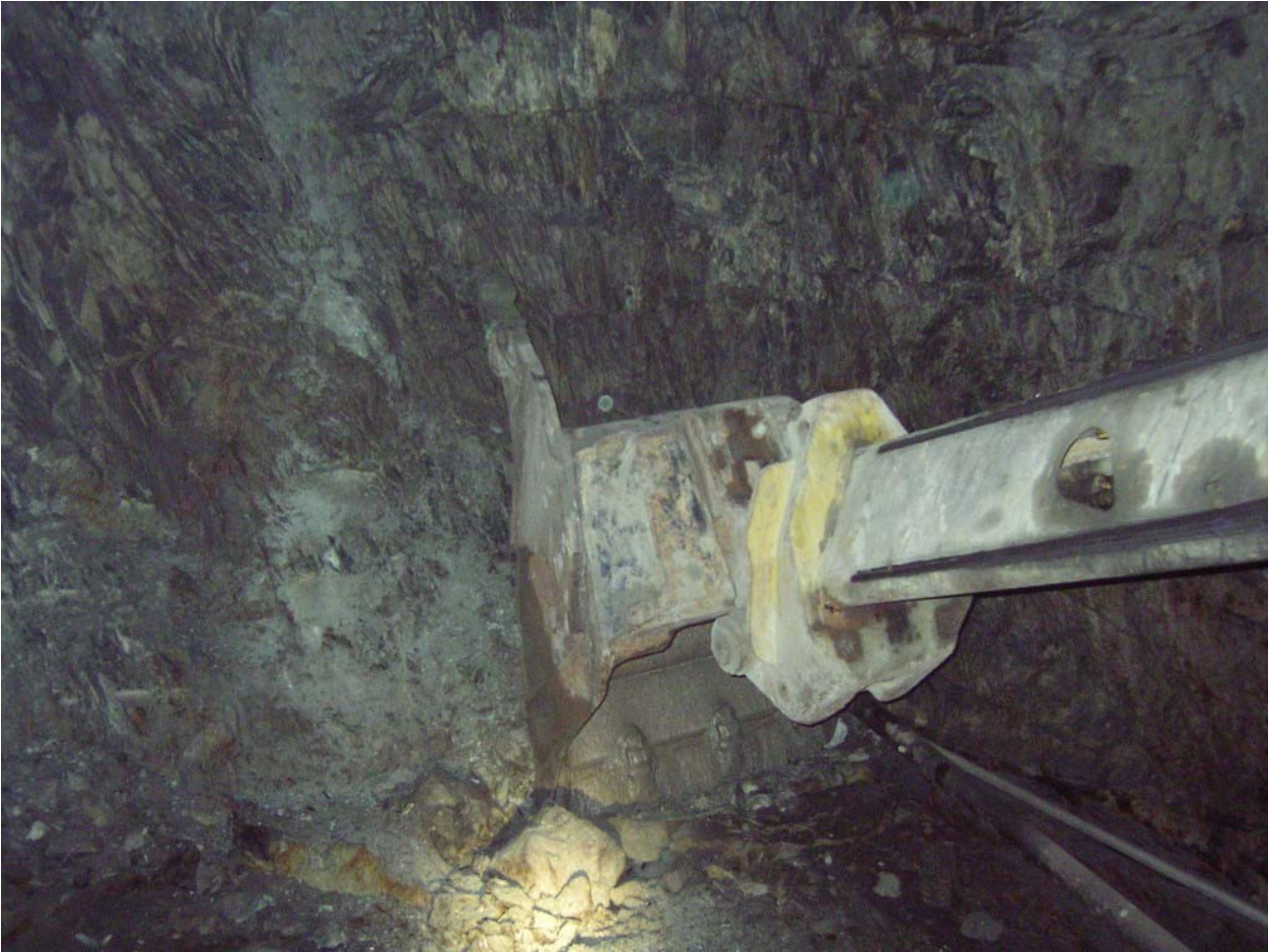
Kuva 4. Tuotantolouhinnassa käytetty rusnauspiikillä varustettu rusnauskoneen kauha .
