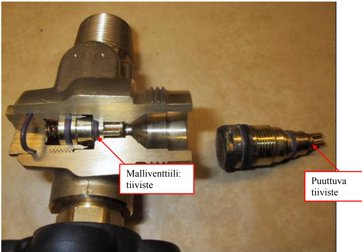
Kuva 12 Vastapaineventtiilistä puuttuva tiiviste. Kuvassa on malliventtiili ja onnettomuusventtiilistä oleva osa, josta tiiviste puuttuu.
