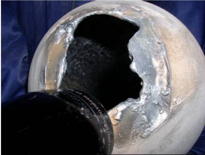
Kuva 6 Happipullo onnettomuuden jälkeen
