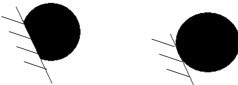
Kuva 15 O-renkaan painuminen venttiilirunkoa vasten. Vasemmalla adapteri ei ole aukaisut ollenkaan (vastaa kiinni asentoa) vastapaineventtiiliä ja oikealla adapteri on aukaisut vain hyvin vähän.
