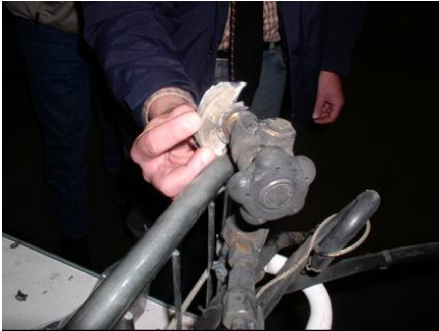
Kuva 8 Pulloventtiili onnettomuuden jälkeen
