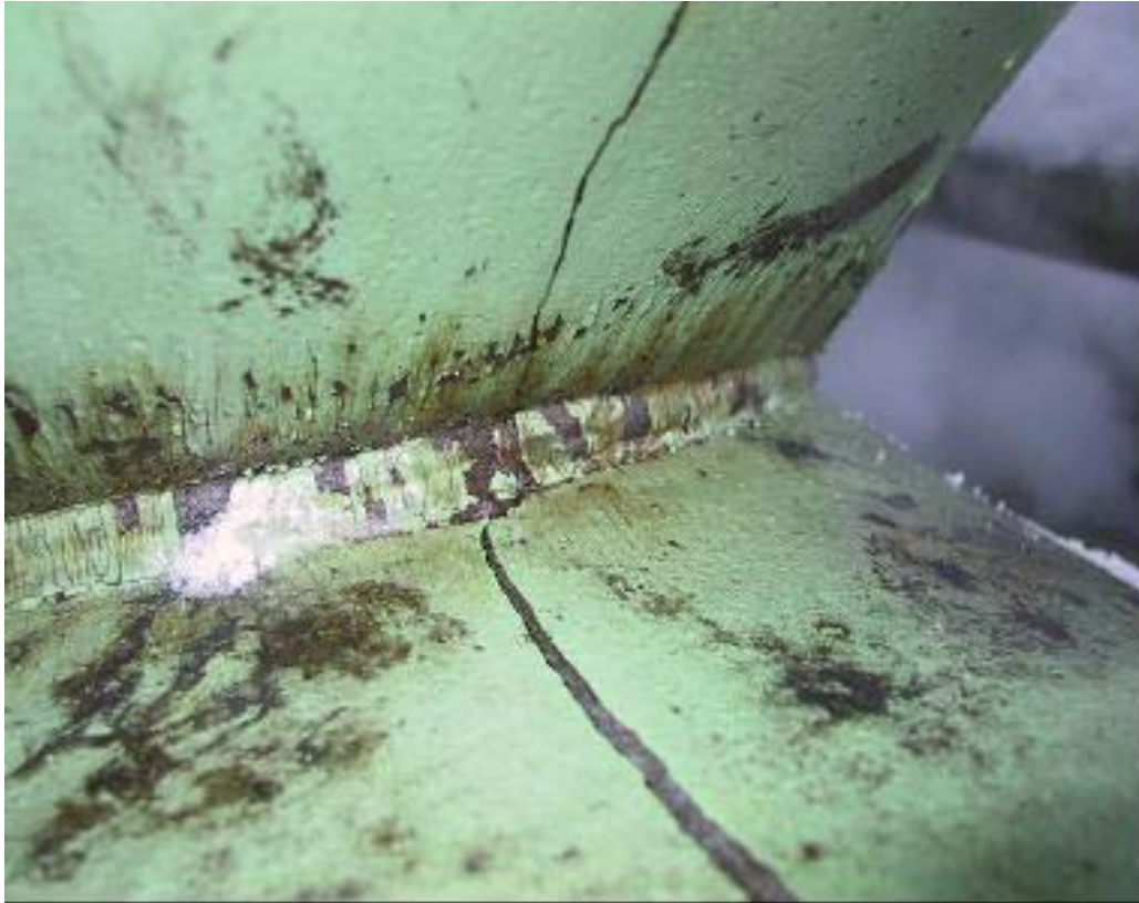
Kuva 3. Hitsin muutosvyöhykkeestä alkanut lohkomurtuma
