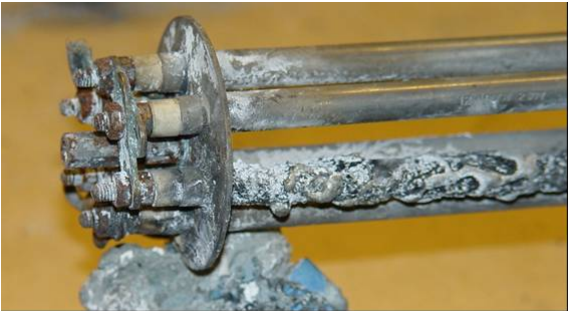
Kuva 4. Tulipalon todennäköisesti aiheuttaneen uppokuumentimen sähkövastuselementit kuvattuna siten, että vastuselementtien yläosa näkyy.
