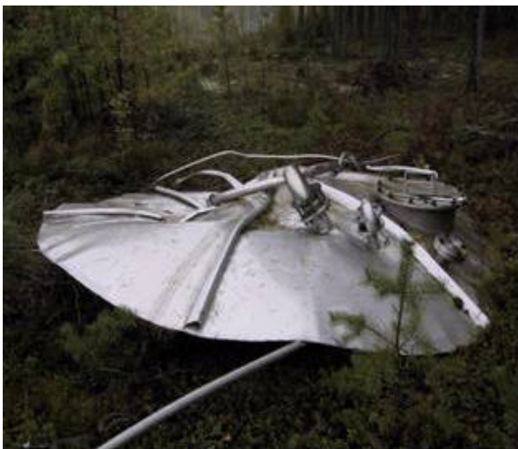
Kuva 4. Säiliön katto lensi teollisuusalueen aidan toiselle puolelle metsään noin 100 metrin päähän säiliöstä
