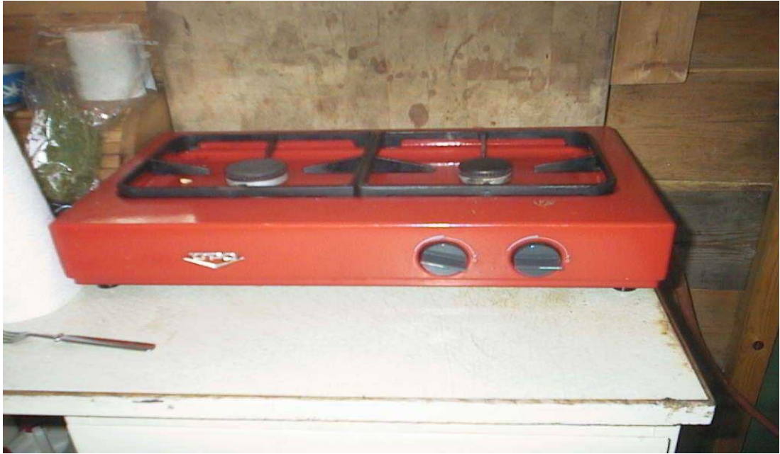
Kuva 1. Keittimen vasemmanpuoleisen polttimen käyttönappi oli käännettynä vastapäivään vasemmalle minimiasennossa.
