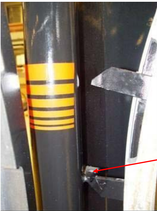
4. Rajatappien sijoittuminen autoklaaviin (kuva ehjästä autoklaavista)
