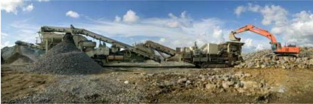
Kuva 3-1. Esimerkki siirrettävästä murskauslaitoksesta
