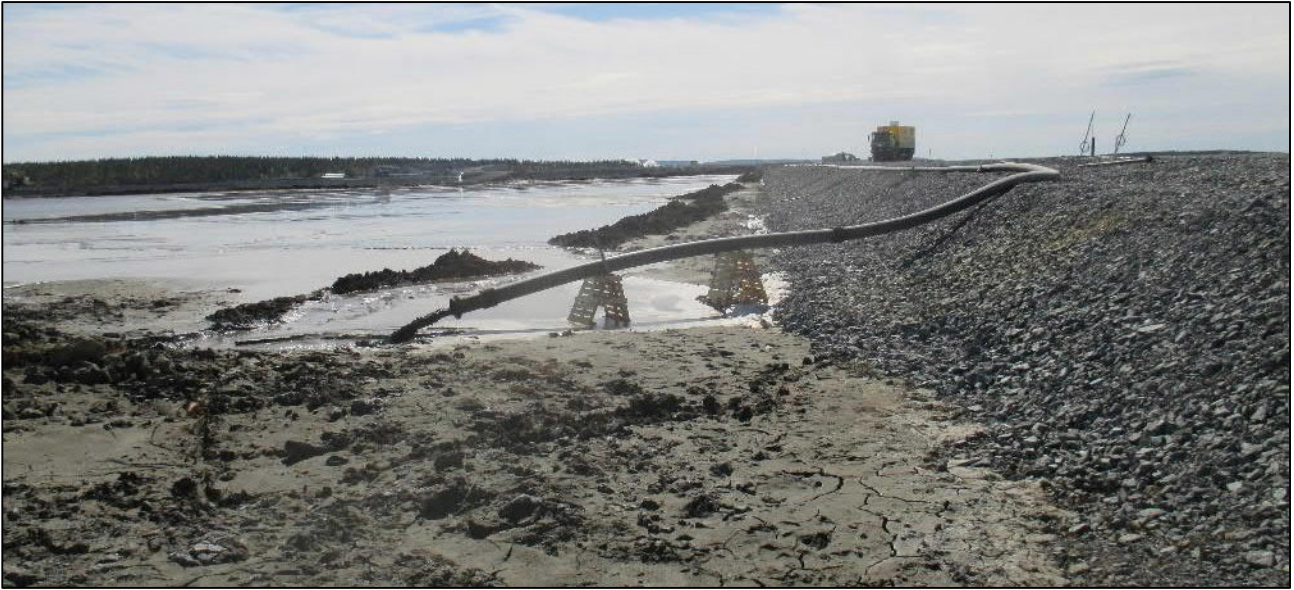
Kuva 11. Rikastushiekan spigotointia. (Kuva: Agnico Eagle Finland Oy)
