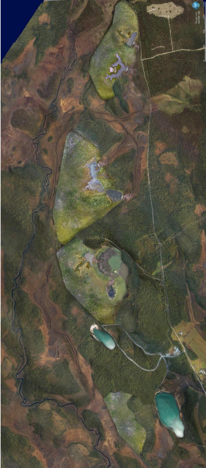
Kuva 22 Kittilän kaivosalueen sulkemisvisio ehdotetun perusskenaarion sulkemisvaihtoehtoon mukaisesti. Ehdotettu esitys kasvillisuudesta on vain käsitteellinen ja seuraa pääasiallista olettamusta, että paikallisen kasvillisuuden annetaan vakiintua biologista monimuotoisuutta edistävät toimenpiteet huomioon ottaen. Lampialueet on esitetty käsitteellisesti mahdollisen lammikoitumisen havainnollistamiseksi. Rajoitettu määrä metsäautoteitä on jätetty tarkoituksella. Niitä tarvitaan oletettavasti pitkän aikavälin ympäristöseurantaa varten. Kuvan on laatinut Tim Write, MEM.
