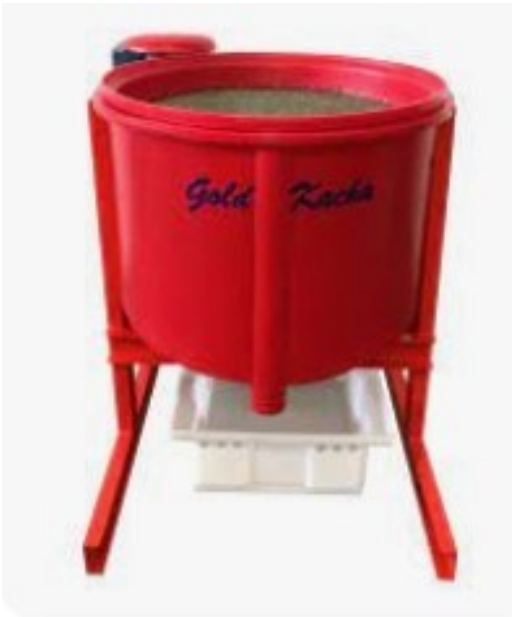
Kuva 3. Vapaan kullan erottelulaite, Gold Kacha -sentrifugi.
