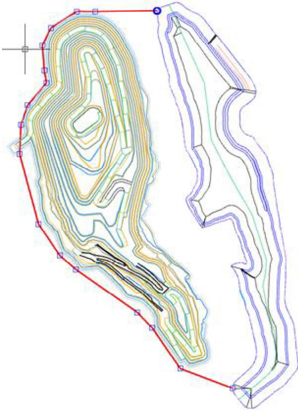
Kuva 4. Kuvassa on esitetty Kuusilammen avolouhoksen ympärille tehtävän aidan sijainti louhoksen ympärillä (aita merkitty kuvaan punaisella viivalla).
