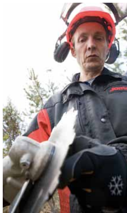
Tylsällä terällä ei kannata sahata. Terä on kunnossa, kun viiden senttimetrin paksuinen puu katkeaa yhdellä sahauksella, Kalervo Lahtinen sanoo.
